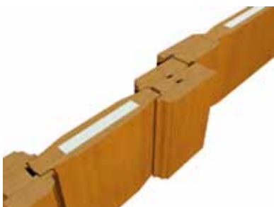
az ajtótokok vastagsága és a hozzá illesztett bevilágító vastagsága
