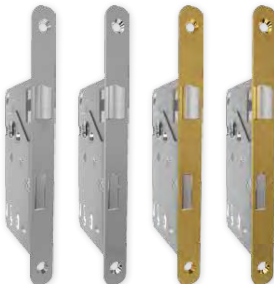
PRIME pánt ezüst vagy arany színű előlappal a furnér kollekciókhoz: a zárnyelv ezüstre csiszolva a szintetikus felületekhez: a zárnyelv matt galvanizált csiszolással „PRIME” pánt, kiskereskedelem : Választható színek: arany, matt arany, ezüst, matt ezüst.
